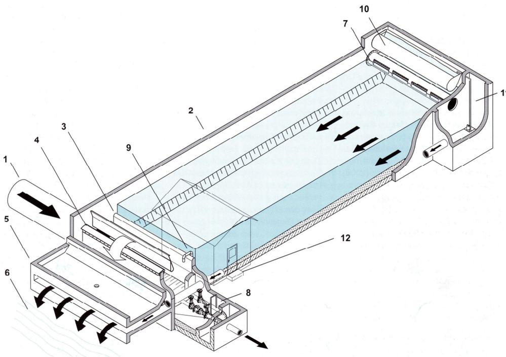
Es importante tener en cuenta que los tanques de tormenta clarificadores no son válidos para cualquier proyecto en el que se deba dar solución a la regulación y retención de las aguas de lluvia, ya que su funcionamiento está condicionado por el tipo de agua de lluvia que entrará en su interior.
