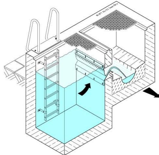
Dicho elemento está compuesto por dos piezas que se colocan sobre toda la longitud del muro o ventana de alivio del depósito. Las dos piezas forman una ranura estrecha por la que debe ser aliviada el agua ‘limpia’, después de haberle dado tiempo a que los contaminantes que arrastraba con ella hayan decantado dentro del tanque de tormentas clarificador.
