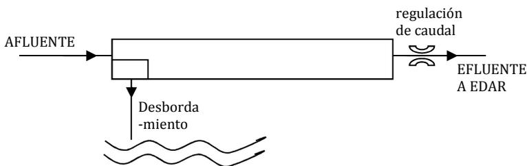
**B-2** Tanque de tormentas en sistema unitario (CSO-tank), modo de funcionamiento first-flush. Diseño tubular con alivio aguas arriba, disposición in-line.
