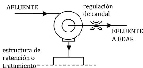
**D-2** Tanque de tormentas compacto o separador por efecto Vortex en sistema unitario; para tratar por sedimentación y aliviar a otra estructura el resto de agua.
