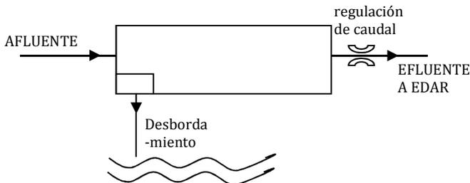
**B-1** Tanque de tormentas en sistema unitario (CSO-tank), modo de funcionamiento first-flush. Diseño rectangular, disposición in-line.
