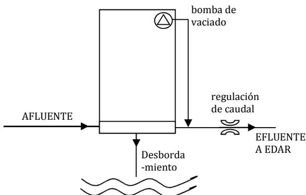
**B-3** Tanque de tormentas en sistema unitario (CSO-tank), modo de funcionamiento first-flush. Diseño rectangular, disposición off-line con vaciado por gravedad o bombas (optativo, sólo si se quiere o necesita hacer en tanque profundo, sino con muro de separación).
