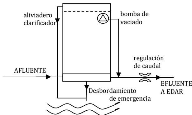
**E-3** Tanque de tormentas clarificador en sistema unitario o separativo (CSO-clarifier tank). Diseño rectangular, disposición off-line con vaciado por bombas o muro de separación.
