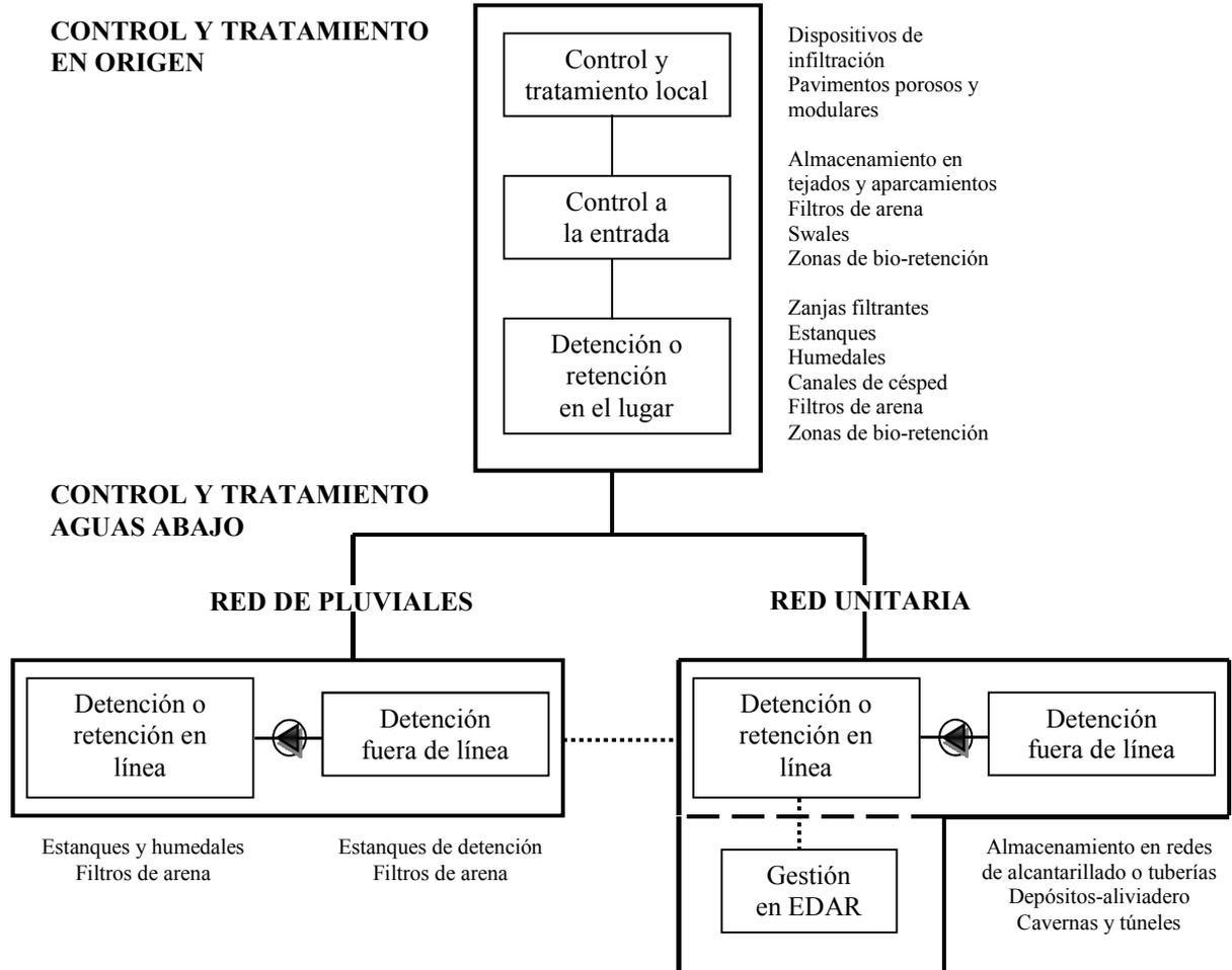
Se puede ver que se diferencia entre las estructuras de retención y las de detención (se llenan y vacían en cada evento de lluvia, desaguan a colector), así como las implementadas en los sistemas unitarios y separativos.
