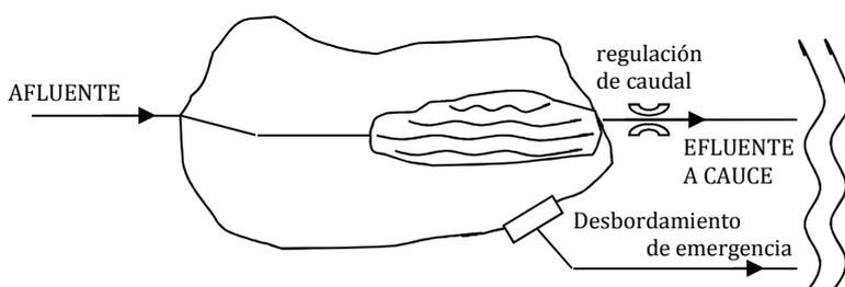
**E-6** Balsa de tormentas en sistema separativo; para regulación de caudales a cauce y reducción de caudales punta, con retención y tratamiento parcial de la escorrentía por sedimentación. Estructura semi-inundada.
