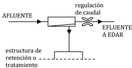
**A-2** Cámara de regulación de caudal, derivando el exceso hacia estructura de retención o tratamiento.
