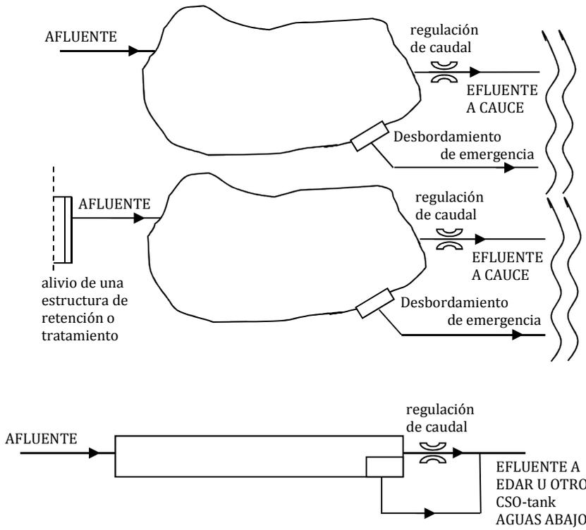
**B-4** Balsa de tormentas en redes pluviales (sistema separativo); regulación de caudal a cauce y detención o reducción de caudales punta.
