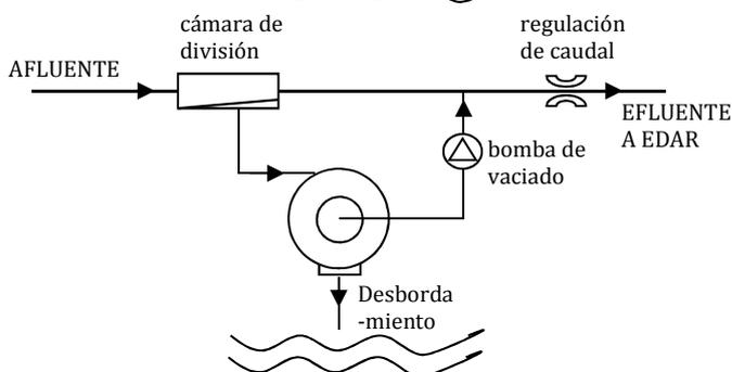
**E-5** Tanque de tormentas compacto o separador por efecto Vortex para sistema unitario. Disposición off-line con vaciado por bombas (utilizadas sólo en periodo de lluvia).
