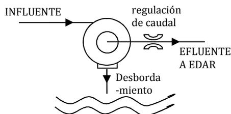
**E-4** Tanque de tormentas compacto o separador por efecto Vortex para sistema unitario. Disposición in-line.
