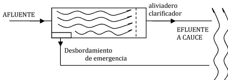
**D-1** Tanque de tormentas clarificador (o de detención) en sistema separativo para tratamiento de la escorrentía por sedimentación. Con aliviadero de emergencia para evitar resuspensión de lodos.
