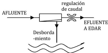
**A-1** Aliviadero en sistema unitario (sin retención de volumen) o aliviadero de emergencia aguas arriba de un tanque de retención.
