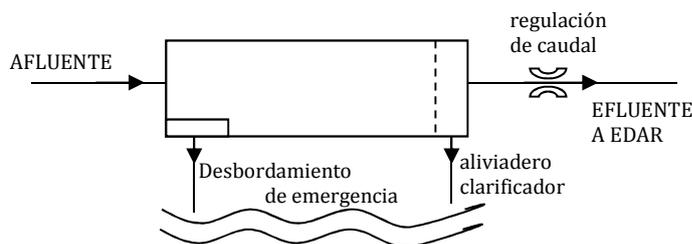
**E-2** Tanque de tormentas clarificador en sistema unitario o separativo (CSO-clarifier tank). Diseño rectangular, disposición in-line. Estructura más eficaz que un tanque de tormenta first-flush por lograr mayor sedimentación de los contaminantes arrastrados.
