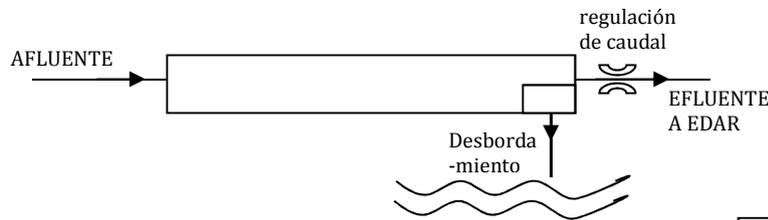
**E-1** Tanque de tormentas en sistema unitario (CSO- tank). Diseño tubular o rectangular, disposición in-line. Alivio aguas abajo; riesgo de removilización de sedimentos!
