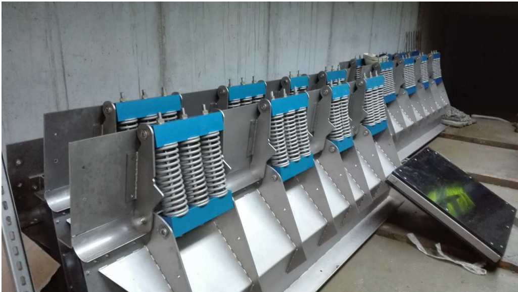
Flaps del tanque de tormentas finalizados (están del revés)
